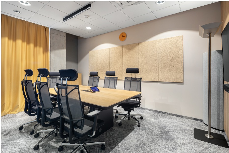
1. Makro Cash & Carry, Warszawa, WEŁNA DRZEWNA Wall Absorber Heradesign Superfine 25mm AK01 Nature13 , Antaris Tegalur15
